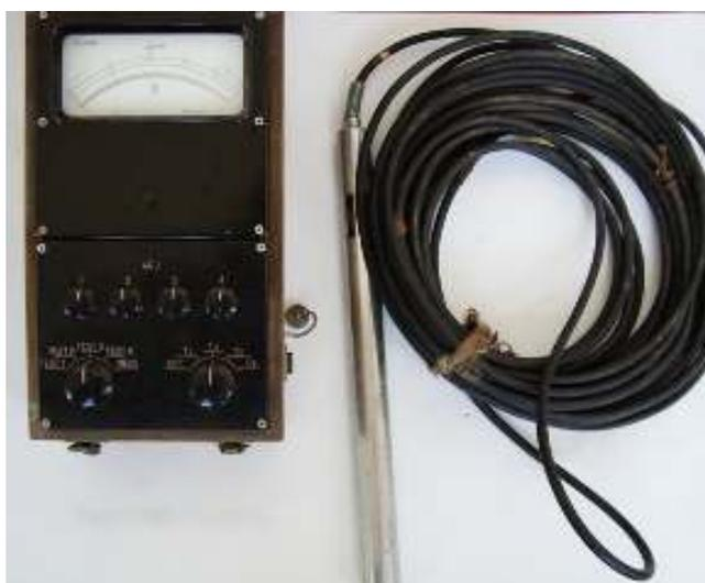
**Figura 3.** Sonda multiparâmetro antiga com cabo e painel de visualização (Fonte: autores)
