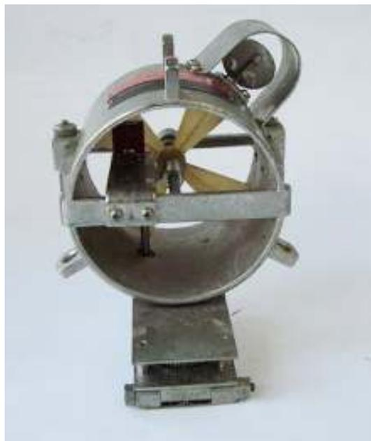
**Figura 5.** Detalhe da hélice do fluxômetro (Fonte: autores)
