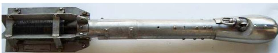
**Figura 1.** Batitermógrafo (BT) com protetor de nariz. (Fonte: autores)
