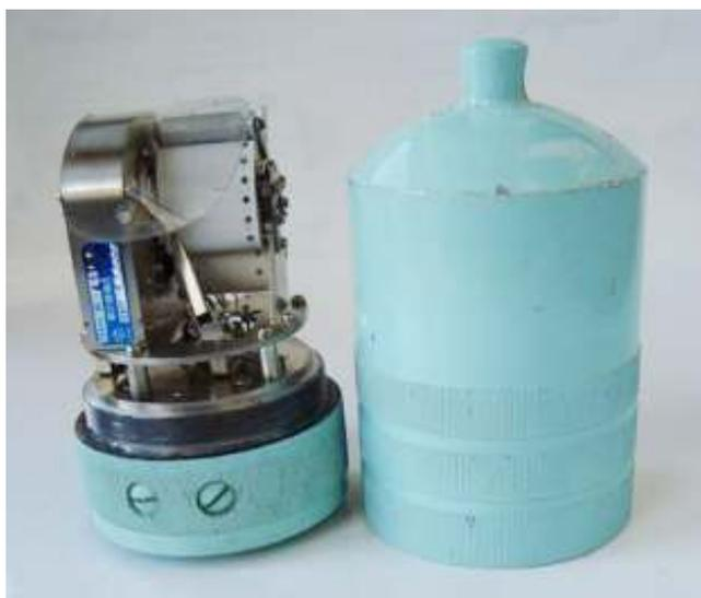
**Figura 2.** Mecanismo de gravação de dados, tipo tambor de relógio, do medidor de profundidade (Fonte: autores)
