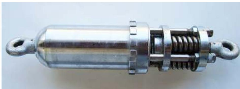
**Figura 6.** Avaliador de tensão com o protetor (Fonte: autores)
