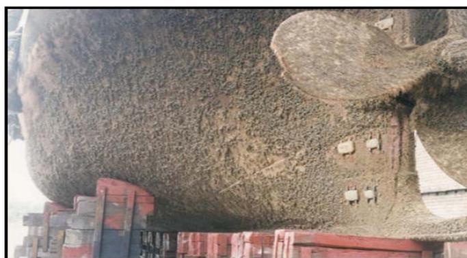
Figura 7 – Casco com incrustação
