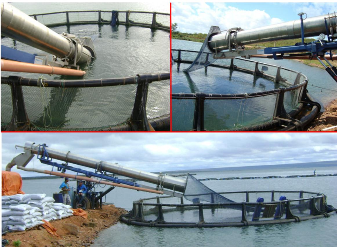
Figura 3. Tanques em PAD de grande volume e máquina de despesca
