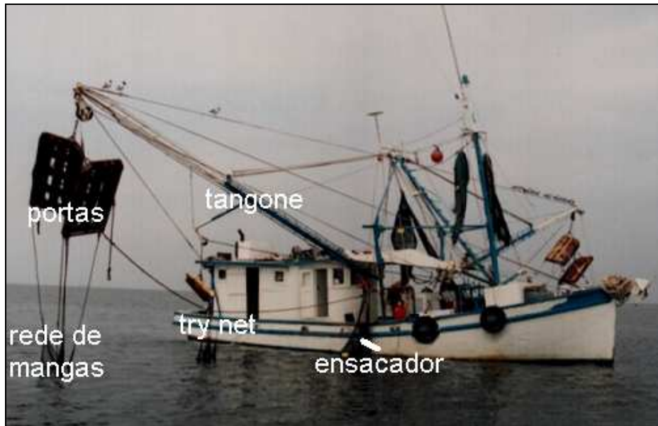
FIGURA 6 - Típico arrasteiro duplo de portas, destacando os equipamentos diretamente responsáveis pela captura do camarão, como portas, redes de manga e tangones. O “try-net” é uma rede de portas disposta na popa da embarcação, com dimensões bem inferiores das principais e serve para se verificar a área de arrasto se mostra satisfatória para captura.
