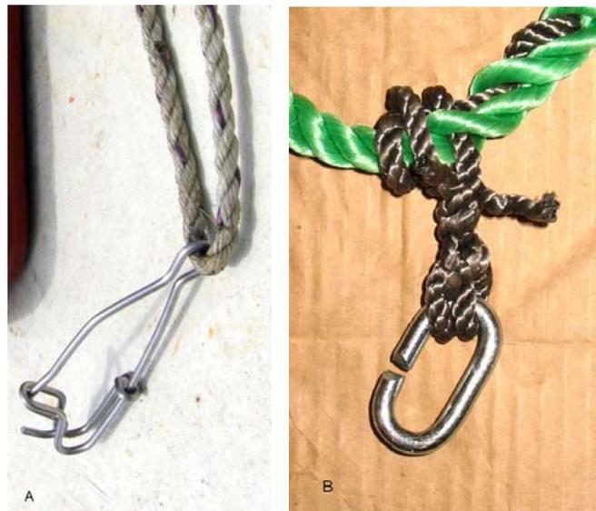
**Figura 20.** A – Grampo metálico (snape) ; B – Elo de corrente metálica.
