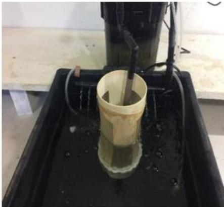
FIGURA 8 - Filtro Canister com Inoculo
