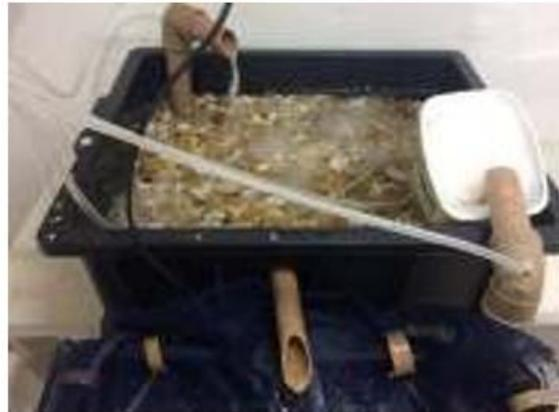
FIGURA 9 - Filtro Dinâmico com inoculo
